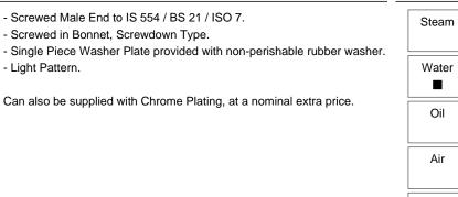
Test Pressure (Hydraulic) Shell : 20 kg/cm<sup>2</sup>g (285 psig) Seat : 13.50 kg/cm<sup>2</sup>g (192 psig)
